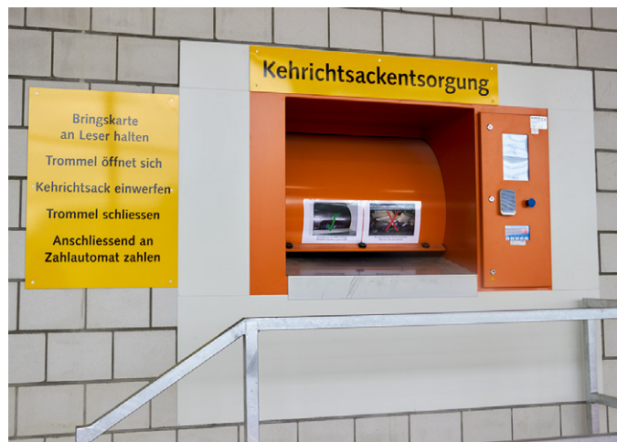
Kehrichtsäcke werden automatisch gewogen und verrechnet. Es gilt das Verursacherprinzip.
