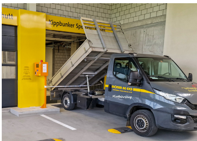
Les entreprises peuvent décharger leurs véhicules directement dans les trémies basculantes.
