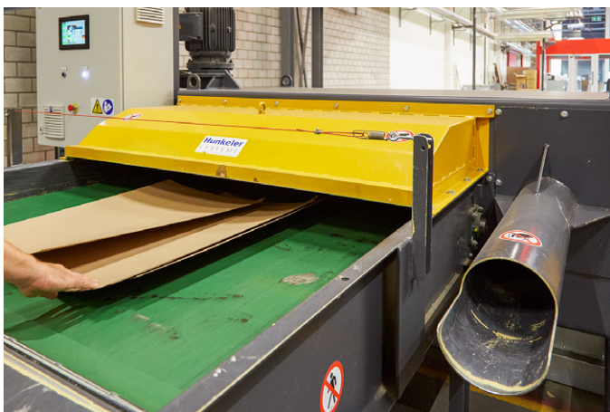
Flachkarton, Schwarten und Rollenhülsen werden über einen manuell beschickten Schredder zerkleinert und entsorgt.
