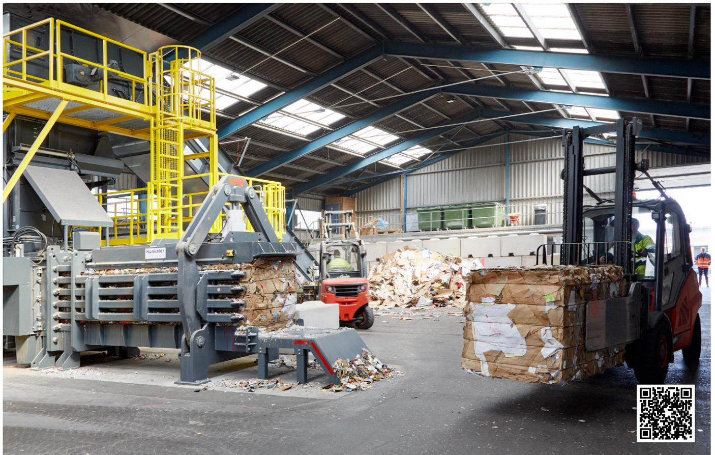
Die Presse verdichtet Papier und Karton zu Ballen mit einem Gewicht von bis zu einer Tonne. Bis zu 5,5 Tonnen Material werden innerhalb von zwanzig Minuten verarbeitet.
