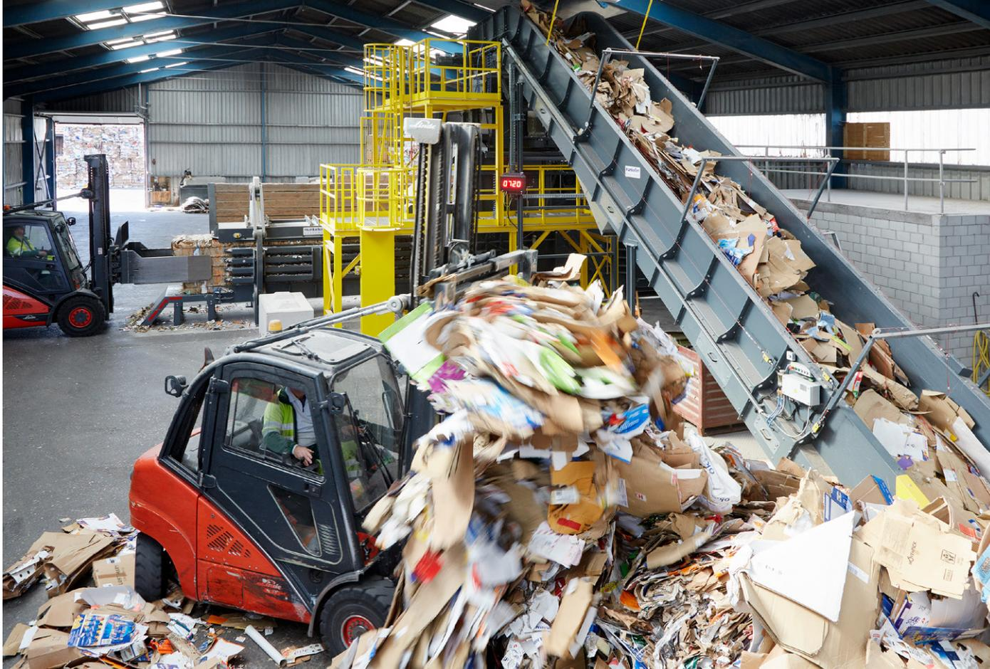
Für ein jährliches Volumen von 15 000 Tonnen ist die Ballenpresse ausgelegt. Sie arbeitet sparsam; ein Frequenzumrichter steuert den Betrieb. Die Presse nimmt nur dann elektrische Energie auf, wenn Material zu verdichten ist.
