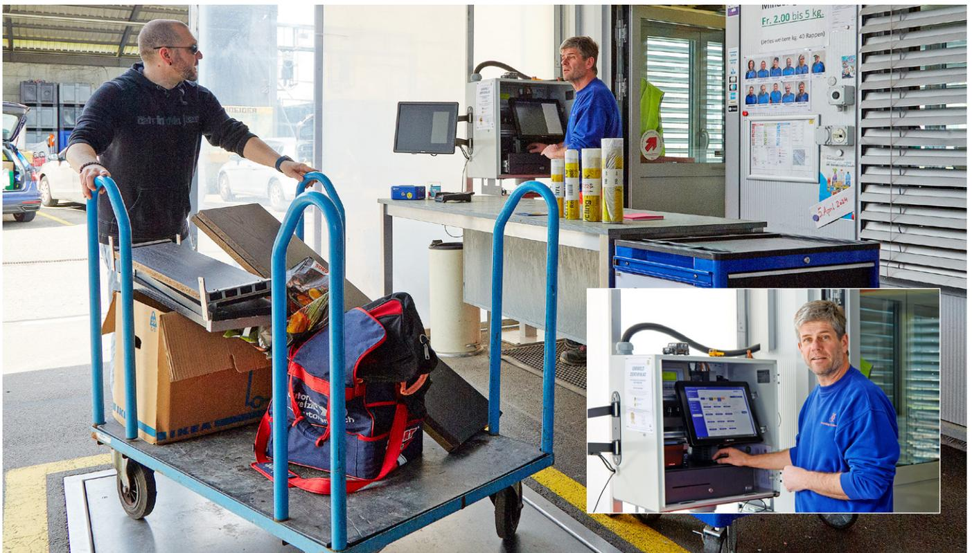
La ville de Dübendorf a réalisé son système de caisse électronique avec la technique de pesage et le logiciel CashConnect de Hunkeler Systeme AG. Roland Keller, responsable du recyclage et de l'élimination (petite photo), peut sélectionner les types de déchets à l'écran. CashConnect enregistre automatiquement les quantités et le montant de l'argent.
