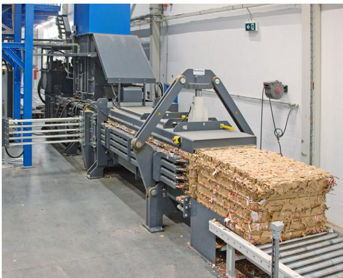
Au cours d'une opération de calage, de très grandes quantités de carton ondulé doivent être broyées et transférées pneumatiquement vers la presse à balles dans un laps de temps très court.
