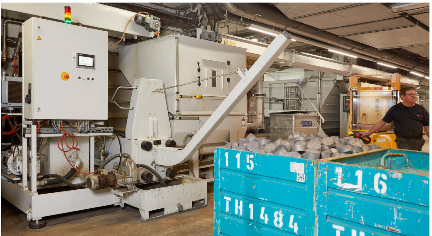
Der Produktionsbetrieb muss sich darauf verlassen können, dass die Brikettpresse stabil funktioniert, immer vierschichtig, während 24 Stunden an sieben Tagen.
