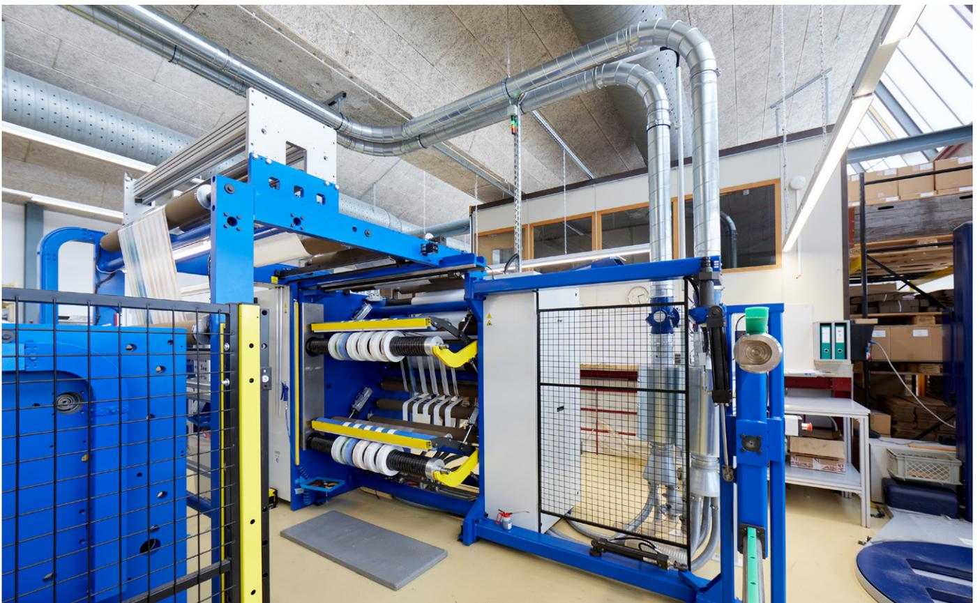
Der Rollenschneider arbeitet mit einer Bahngeschwindigkeit von 600 Metern pro Minute. Die Plastikstreifen werden in einem Schneidwerk (zylindrische Elemente im unteren Bereich) zerkleinert und über die Rohrleitungen entsorgt.
