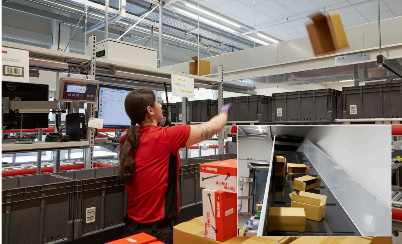
Ein Förderband (kleines Bild) transportiert die entleerten Kartonschachteln in den Aussenbereich, dort werden die Schachteln in einem Presscontainer verdichtet.
