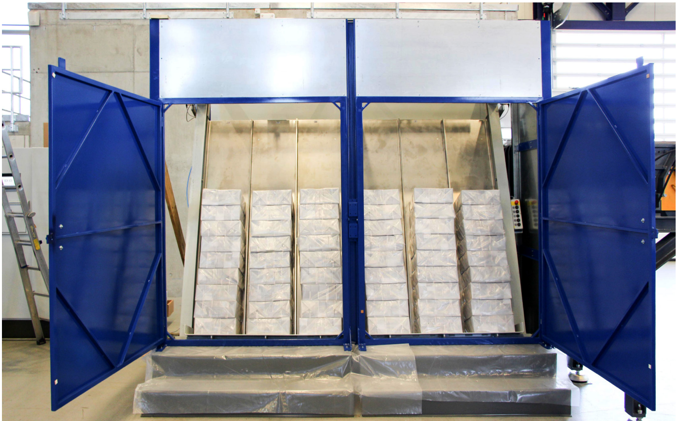
Le Hunkeler Compact Buffer HCB 600 peut contenir jusqu'à 600 kilogrammes de billets de banque.
