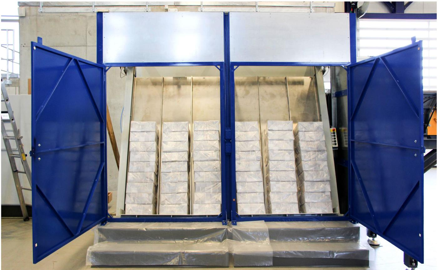
Der Hunkeler Compact Buffer HCB 600 fasst bis zu 600 Kilogramm Banknotenscheine.
