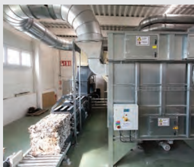
Presse à balles, traitement efficace des déchets à l'éjection
