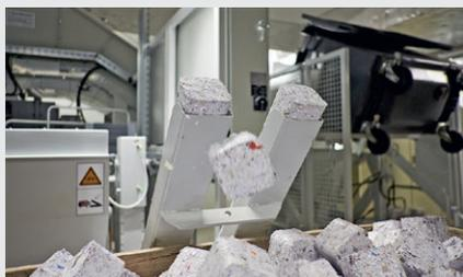
En option le Hunkeler Document Destruction System HDDS 30 peut être raccordé en aval à une presse à briquettes. La presse compacte les particules en briquettes denses. Le volume est réduit dans un rapport de 1:12, pour une densité d'un kilogramme par décimètre cube. A part le matériel broyé, la poussière produite pendant les processus de broyage, est également traitée.
