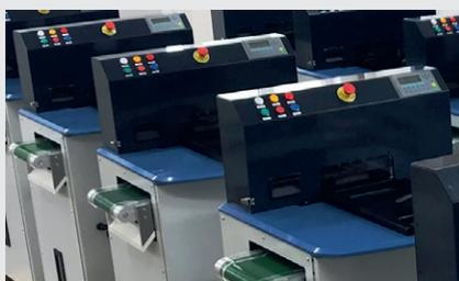
Le Hunkeler puncher HBP 100 est un système hors ligne, commandé manuellement pour dévaloriser les billets de banque ou autres papiers valeurs. Un module de poinçonnage entraîné par hydraulique traite des liasses avec jusqu'à 100 billets de banque, la capacité atteint jusqu'à quinze liasses par minute. Le HBP 100 trouve son domaine d'application principalement où les billets de banque dévalorisés doivent être transportés entre deux sites éloignés l'un de l'autre.
