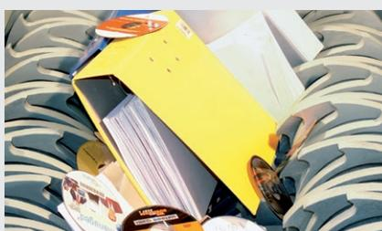
A part les billets de banques et autres papiers valeurs, l'ensemble de coupe du broyeur puissant à quatre arbres détruit dans le HDDS aussi du matériel dur et lourd. Des dossiers entiers avec contenu, des supports de données électroniques, disques durs d'ordinateur, portables, tablettes ou ordinateurs portables sont détruits par le HDDS 30 complètement et de façon irréversible. Le processus de destruction répond à des normes strictes selon DIN 66399 sur le niveau de sécurité H5.
