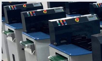
Der Hunkeler Banknoten-Puncher HBP 100 ist ein manuell bedientes Offline-System für das Entwerten von Banknoten und anderen Wertpapieren. Ein hydraulisch angetriebenes Stanzmodul verarbeitet Bündel mit bis zu hundert Banknoten, die Leistung erreicht bis zu fünfzehn Bündel pro Minute. Der HBP 100 findet vornehmlich dort sein Einsatzgebiet, wo entwertete Banknoten zwischen weiter auseinanderliegenden Standorten transportiert werden müssen.
