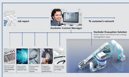
Der Hunkeler Control- und Workflow-Manager zeichnet den gesamten Vernichtungsprozess auf. Er stellt sicher, dass ausschliesslich autorisierte Personen über ihre Login-Daten Zugang zum System erhalten. Jeder einzelne Schritt ist in einem Protokoll festgehalten und kann benutzerbezogen zurückverfolgt werden. Alle relevanten Informationen und der aktuelle Betriebszustand des Zerkleinerungssystems sind auf einem Dashboard gut erfassbar dargestellt.
