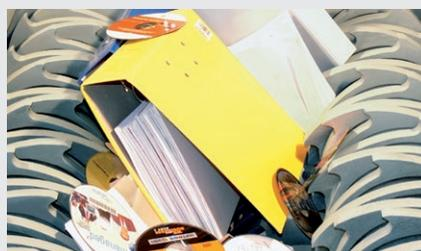
Neben Banknoten und anderen Wertpapieren vernichtet das kräftige Vierwellenzerkleinerungswerk im HDDS 30 auch hartes und schweres Material. Ganze Ordner mit Inhalt, elektronische Datenträger, Computer-Festplatten, Smartphones, Tablets oder Laptops zerstört der HDDS 30 vollständig und irreversibel. Der Vernichtungsprozess erfüllt die strengen Vorgaben gemäss DIN 66399 auf der Sicherheitsstufe H5.
