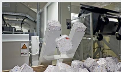
Optional kann dem Hunkeler Document Destruction System HDDS 30 eine Brikettierpresse nachgeschaltet werden. Die Presse verdichtet die Partikel zu kompakten Briketts. Das Volumen wird in einem Verhältnis von 1:12 reduziert, bei einer Dichte von einem Kilogramm pro Kubikdezimeter. Neben dem zerkleinerten Material wird der Staub, der während des Zerkleinerungsprozesses entsteht, in den Verdichtungsprozess mit einbezogen.
