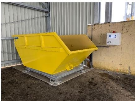
**Les balances au sol** peuvent être utilisées à des fins très diverses. Selon le domaine d'application, ces balances peuvent être fabriquées sur mesure et peuvent être utilisées pour des bennes ou des conteneurs spéciaux. Elles disposent généralement d'une capacité de charge allant jusqu'à 10 tonnes et d'une précision de mesure de 2 kg.
