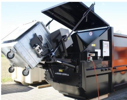
**Les balances pour basculeurs élévateurs** vident les conteneurs directement dans des presses après identification du client, et déterminent le poids des conteneurs avant et après le processus de basculement. Les données collectées sont ensuite transmises sans fil au système de gestion afin de permettre une facturation selon le principe de causalité.
