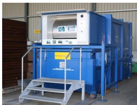
**Les sas de pesée** sont particulièrement adaptés à la réception des sacs poubelles. Après une identification réussie, les clients peuvent éliminer les sacs poubelles via le sas de pesée et ceux-ci sont facturés selon le principe de causalité. Les sas de pesage sont particulièrement adaptés en combinaison avec des conteneurs à compactage automatique et existent en tant qu'unités fixes et mobiles (intégrées dans les conteneurs à compactage).
