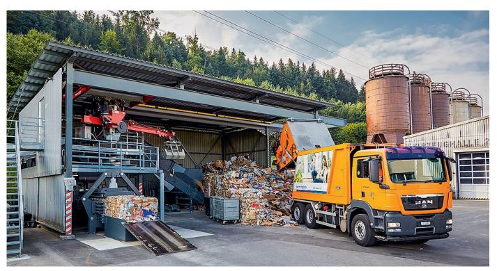
La déchetterie à Ibach compacte chaque année environ 2000 tonnes de carton en balles. Le matériel est utilisé pour la fabrication de carton ondulé.
