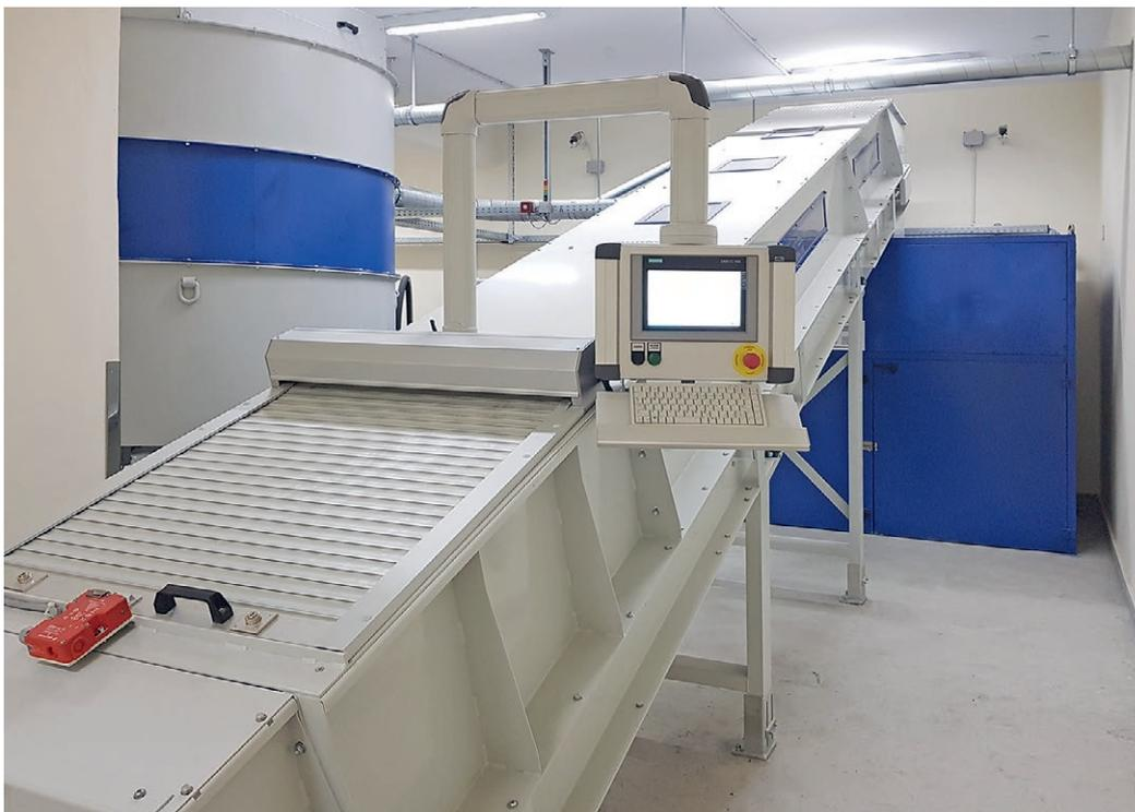
Die Zerkleinerungsanlagen der Hunkeler Systeme AG erreichen eine maximale Verarbeitungsleistung von 300 Kilogramm pro Stunde.
