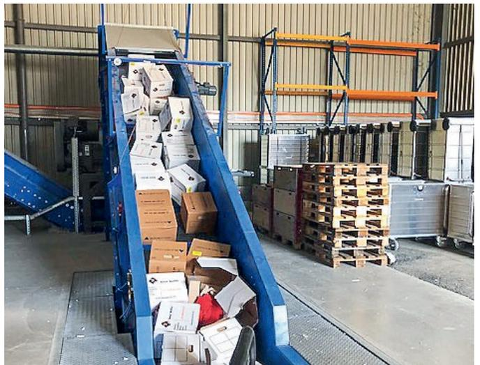
Auf der Anlage werden lose Blätter, Kartonboxen und ganze Bundesordner zu Partikeln gemäss Sicherheitsstufe P4 zerkleinert.
