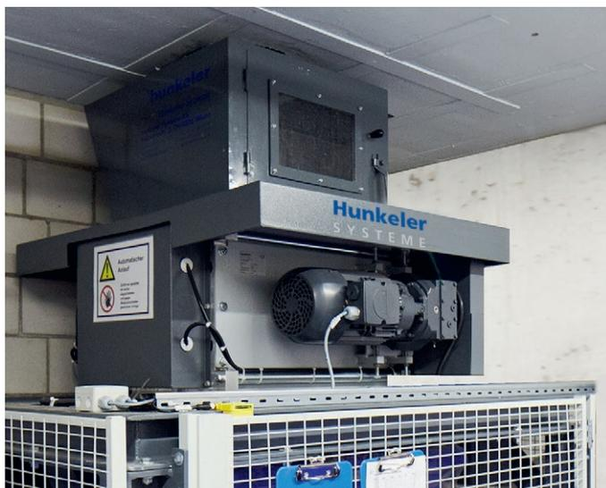
En comparaison avec du matériel non compacté, le volume des déchets est réduit jusqu'à un facteur quatre, grâce au perforateur PET.
