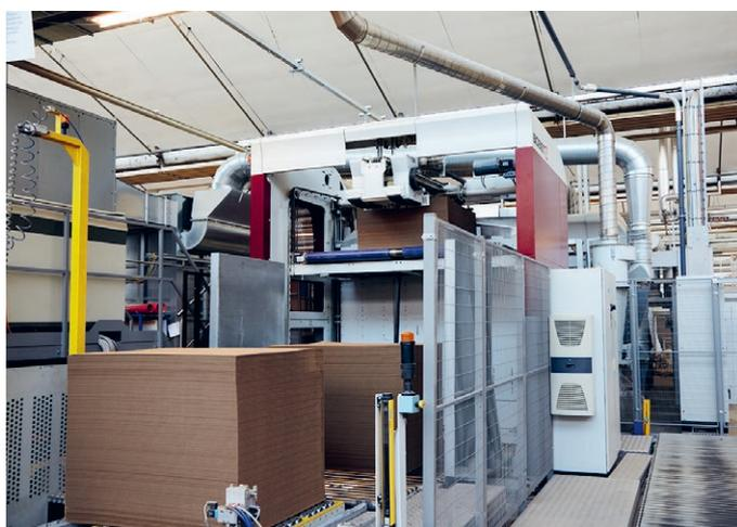
Sur six presses de découpe à plat et cinq découpeuses rotatives inliner l'entreprise traite le matériel en ébauches de boîtes, exécution sur mesure.
