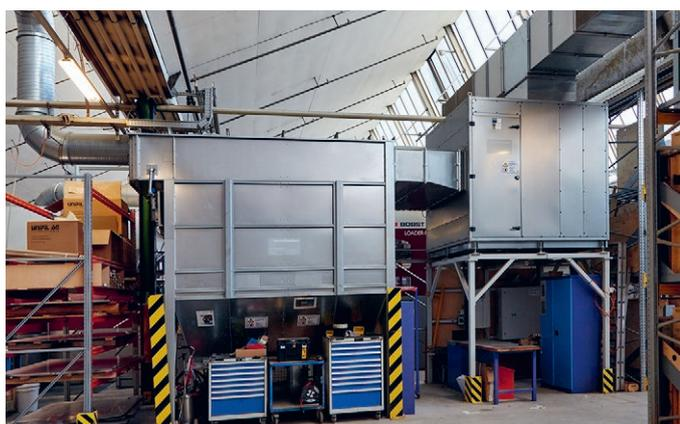
Les lisières, les entre-coupes et les déchets de séparation de pause, qui sont produits pendant le processus de traitement, sont enlevés de la zone de production par une technique d'aspiration et des bandes transporteuses et alimentés à la presse à balles.
