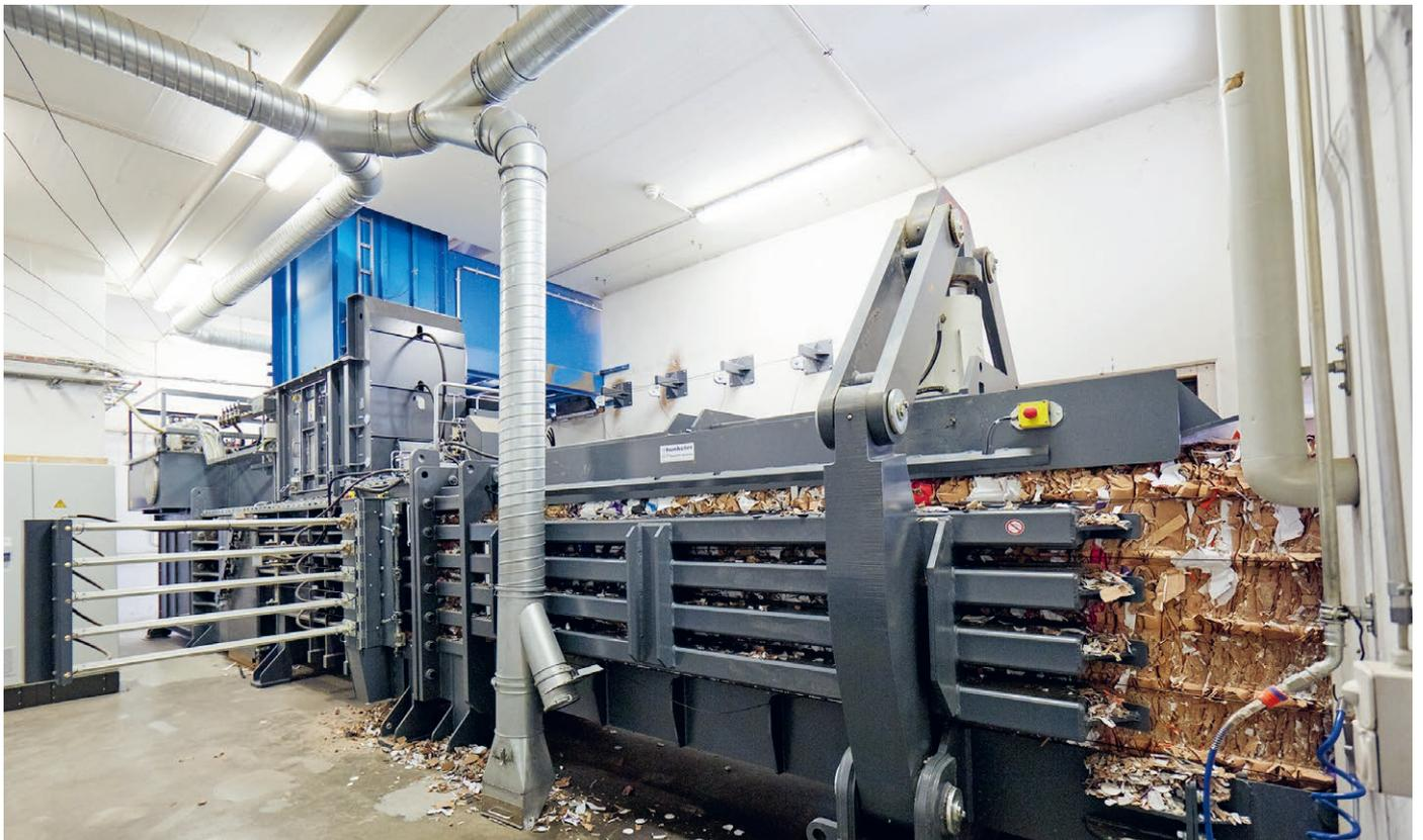
La presse compacte par jour entre 60 et 80 balles, chacune avec un poids de 1.1 tonnes et une grandeur de 110×110×140 centimètres. Pour une force de pression de 120 tonnes, sont responsables deux moteurs électriques, modulés en fréquence.
