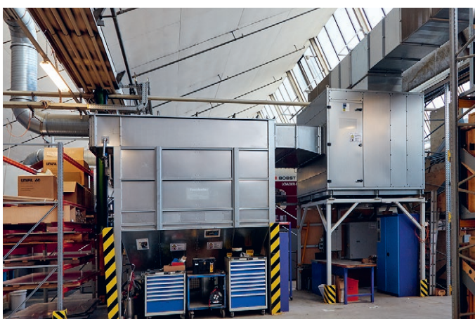
Der Randbeschnitt, Zwischenschnitte und die Stanzgitter, die während des Verarbeitungsprozesses anfallen, werden über Absaugtechnik und Förderbänder aus dem Produktionsbereich entfernt und der Ballenpresse zugeführt.
