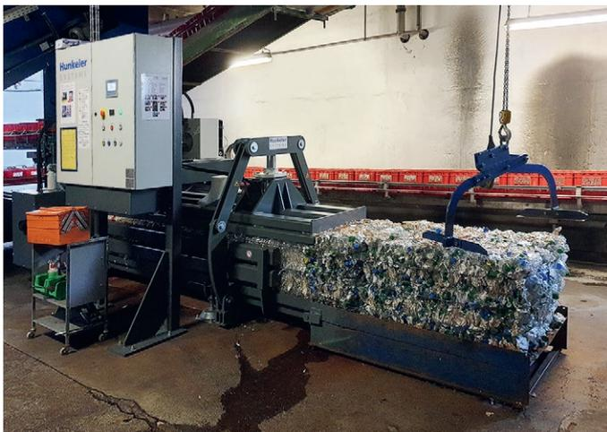
Eine neue PET-Ballenpresse mit einem Compactor-Modul ersetzt eine Anlage aus dem Jahr 2005.
