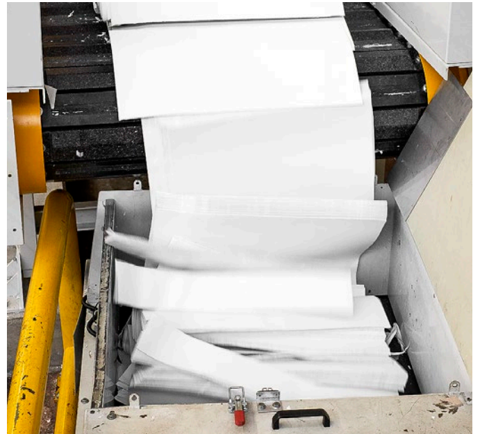
In einem geschlossenen System ubergibt ein Forderband die Stapel der Rolle nach dem Spaltvorgang an einen Schredder mit anschliessendem Granulator
