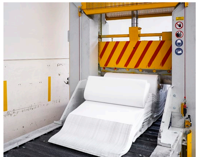
Die Spaltanlage zerkleinert Substratrollen zu Stapel, deren Breite zwischen 20 und 80 Zentimeter variiert werden kann
