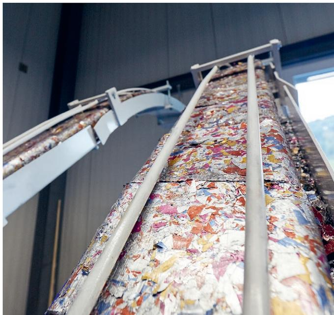
Anschliessend an die Zerkleinerung verdichtet eine Presse die Aluminiumpartikel zu Briketts mit einer Dichte von 1,8 bis 2 Kilogramm pro Kubikdezimeter.
