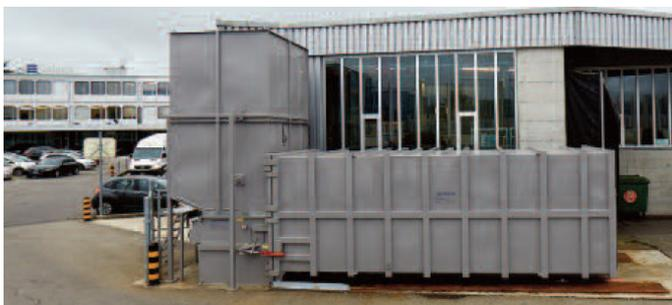
Der Schneckenverdichter bei der Galexis AG verpresst jede Woche rund fünf Tonnen Kartонmaterial.
