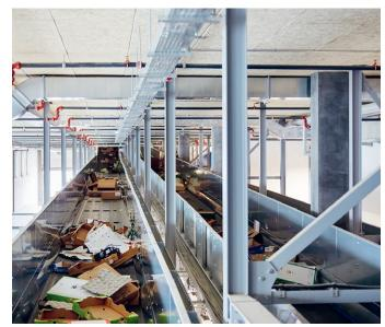
Frequenzumrichter regeln die Geschwindigkeit der Förderbänder in Abhängigkeit der Materialmengen, die zu transportieren sind. Die dynamische Geschwindigkeitssteuerung führt zu einem geringen Verbrauch an elektrischer Energie.
