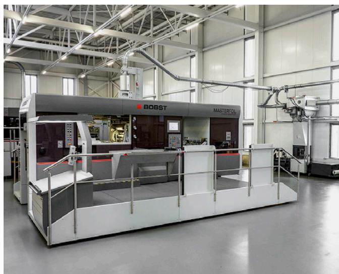
Pour l'évacuation des résidus de production sur les presses de dorure à chaud de BOBST Hunkeler Systeme AG a développé une technique d'aspiration spécifique.
