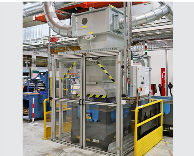
Die Randstreifen werden in einem rotativen Abscheider von der Transportluft getrennt und in einem Container automatisch verdichtet.
