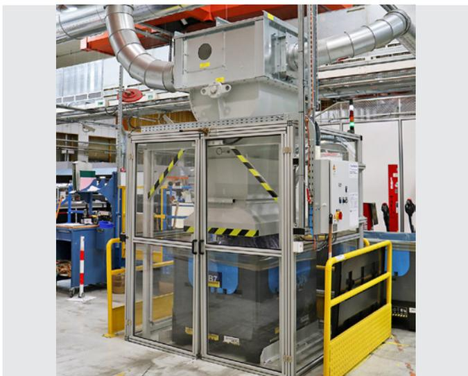
Les bandes de rives sont séparées de l'air de transport par un séparateur rotatif, et compactées automatiquement dans un conteneur.
