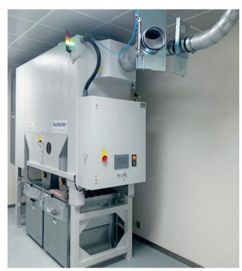
Die HKU 4510 ist für die Anbindung (Anschluss oben im Bild) an einen Offline-Schredder vorbereitet.
