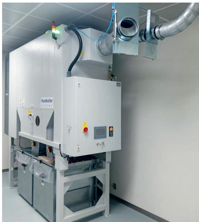
La HKU 4500 est préparée pour une connexion (raccordement voir image ci-dessus) à un broyeur offline.
