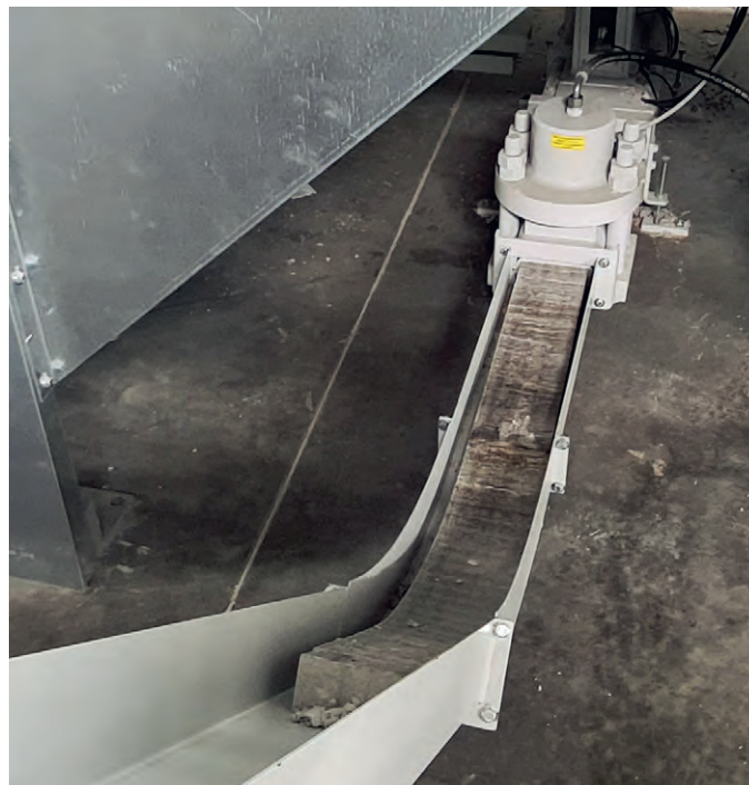
Der Papierstaub wird verpresst und verlässt die Absaug- und Filteranlage in Form kompakter Ballen.
