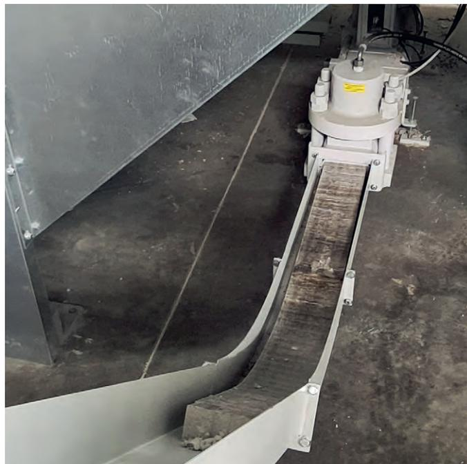
La poussière de papier quitte l'installation d'aspiration et de filtrage en forme de briquettes.
