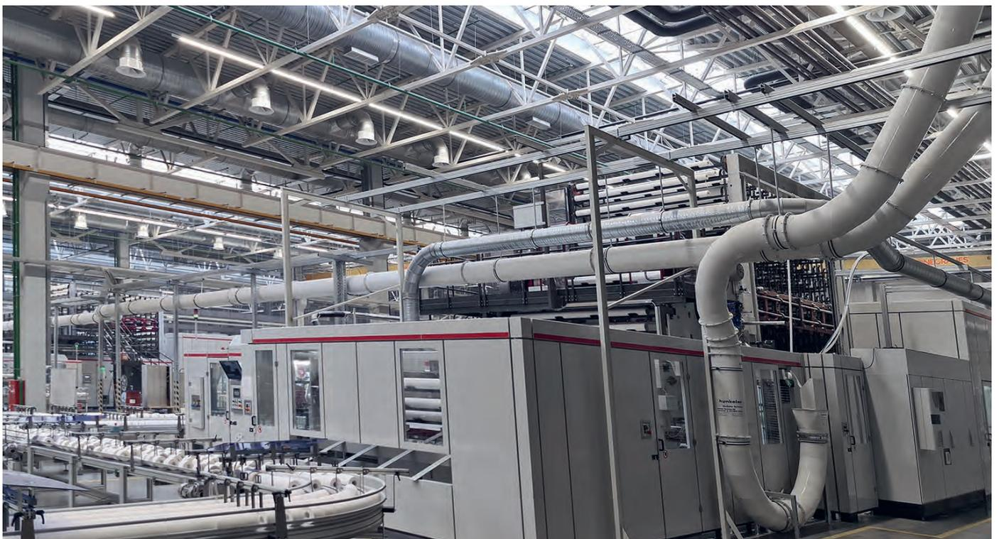
La technique de Hunkeler Systeme AG est raccordée à 42 places d'aspiration. La poussière produite pendant la production, est complètement évacuée, l'air de transport propre est reconduit dans l'environnement.
