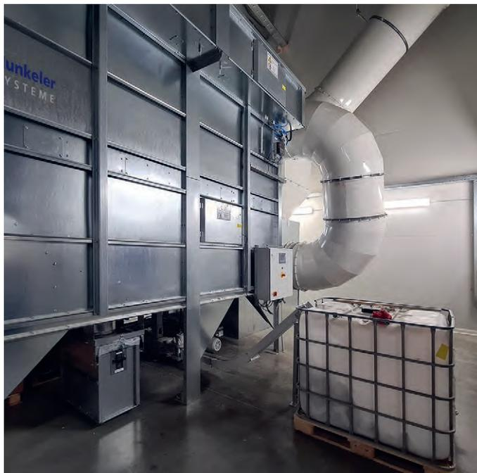
La technologie travaille selon le principe de dépression éprouvé, cependant le ventilateur est positionné à la fin de l'installation.
