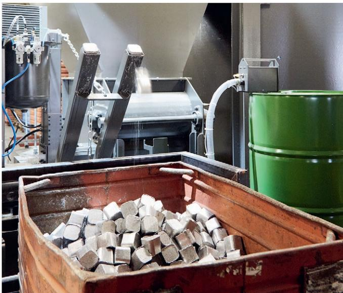
Pro Rezyklierprozess können von den zu Briquets verpressten Aluminiumspänen bis zu 99,5 Prozent der ursprünglichen Einsatzmenge wiederverwertet werden.
