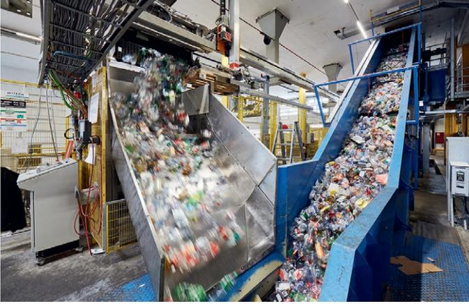
Ein Roboter entleert die Gebinde in einen Aufgabebetrücher, über ein Steigband erreichen die Abfälle die Ballenpresse.
