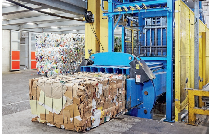
Sur la presse à balles à Dierikon, sont compactés en balles chaque année plus de 6000 tonnes de matériel (carton, PET, PE et films plastique).
