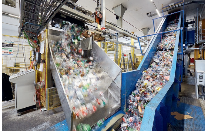
Un robot vide les récipients dans une trémie d'alimentation, par un tapis roulant ascendant les déchets atteignent la presse à balles.
