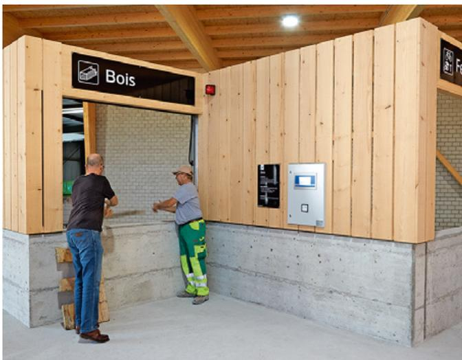
Du bois et des gravats sont évacués dans des auges par une porte à grande dimension. Les auges sont positionnées sur une balance, sur la base du matériel et du poids le badge correspondant est débité.
