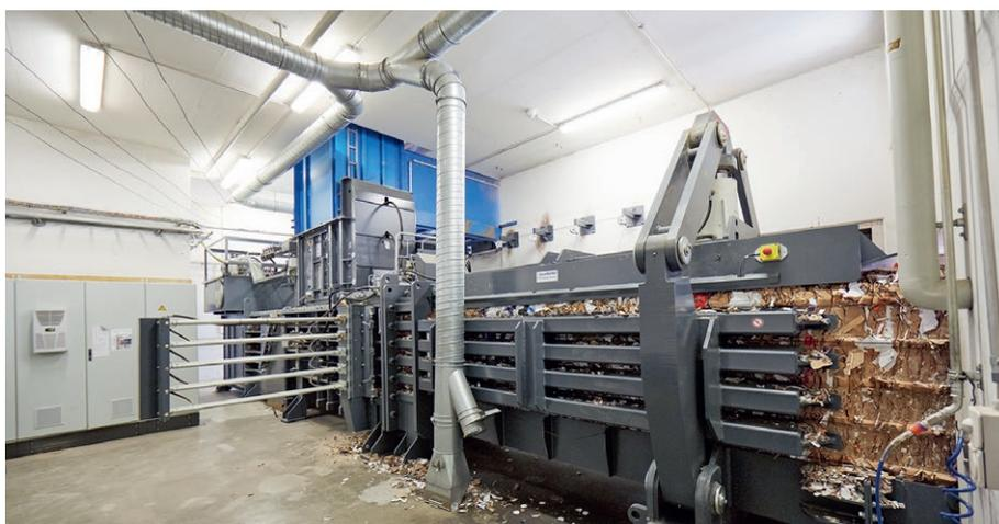
La presse compacte par jour entre 60 et 80 balles, chacune avec un poids de 1.1 tonnes et une grandeur de 110×110×140 centimètres. Pour une force de pression de 120 tonnes, sont responsables deux moteurs électriques, modulés en fréquence.
