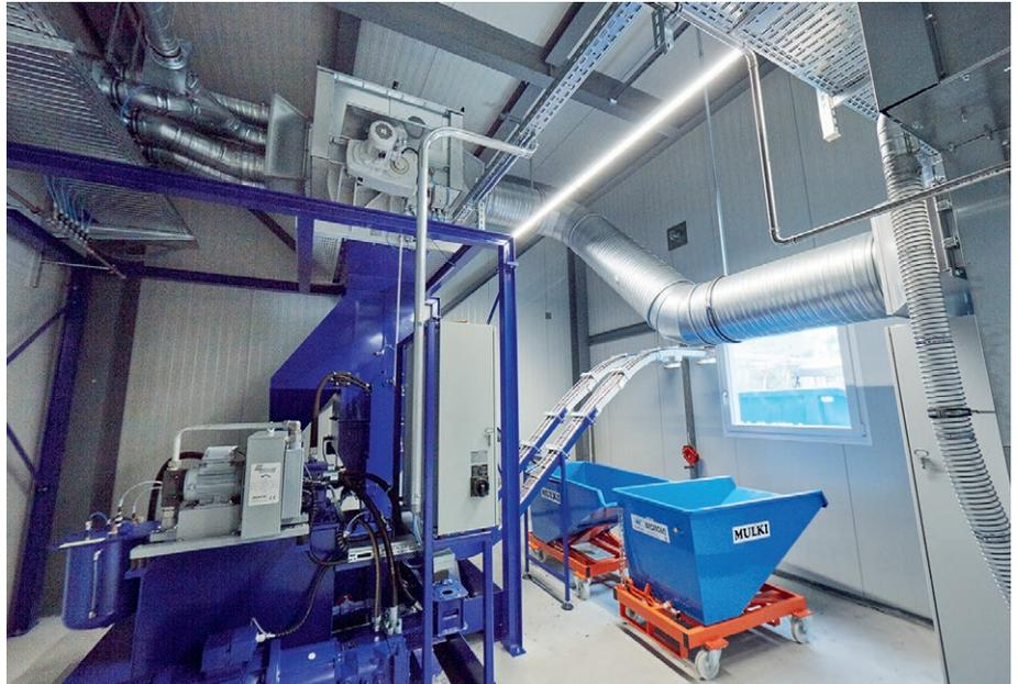
Après le broyage, une presse compacte les particules en briquettes avec une densité de 1.8 jusqu'à 2 kilogrammes par décimètre cube. Par rapport au matériel non compacté, cela correspond à une réduction du volume de 50 pourcents.
