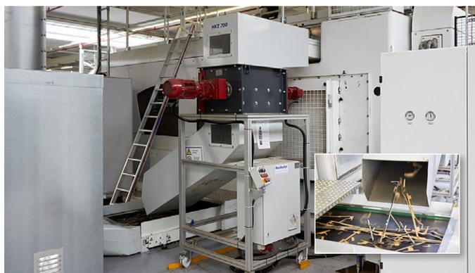
Le broyeur HKZ-700 broie également sans problème des bords de pince plus grands avec des largeurs allant jusqu'à 150 millimètres.
