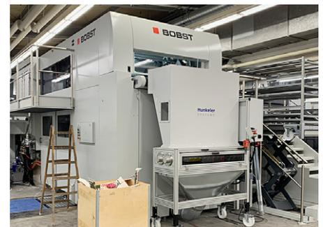
Le broyeur de grilles de poinçonnage SZM a été développé pour une élimination des bords de la pince et des grilles de poinçonnage à faible consommation d'énergie.
