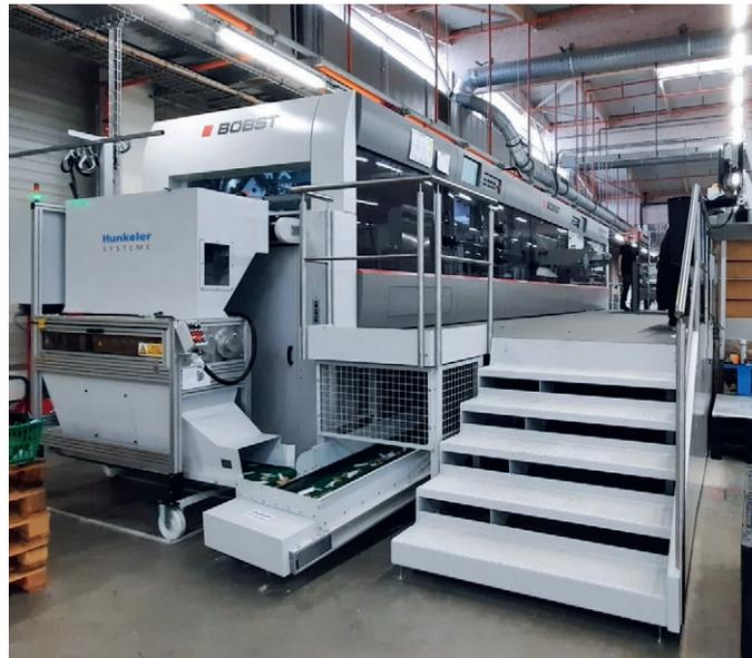
La ligne de transport se déroule au-dessous de la plateforme de la poinçonneuse. L'évacuation des restes de carton demande à peine une surface au sol supplémentaire.
