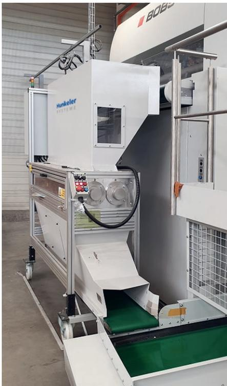
Un convoyeur, ordonné rectangulaire vers le broyeur pour les déchets d'auto-platine, mène les restes de carton au convoyeur central.
