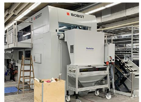
Für eine energieeffiziente Entsorgung der Greiferränder und der Stanzgitter wurde der Stanzgitterzerkleinerer SZM entwickelt.
