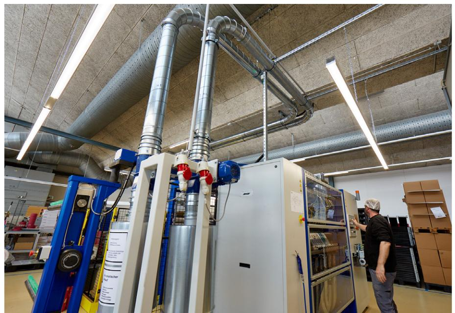
Bei einer Bahngeschwindigkeit von 600 Metern pro Minute werden die Plastikstreifen im Schneidwerk zerkleinert und über Rohrleitungen entsorgt.
