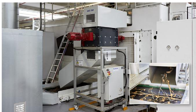
Auch grössere Greiferränder mit Breiten bis zu 150 Millimeter zerkleinert der Schredder HKZ-700 problemlos.
