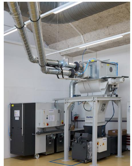
Eine konstante Absaugleistung und Ringionisatoren sichern einen stabilen Prozess bei der Entsorgung des Kunststoffmaterials.
