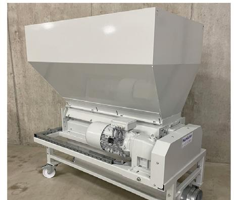
Der Stanzabfallzerkleinerer SAZ zerkleinert die Abfälle an der Mittenausbruchstation
