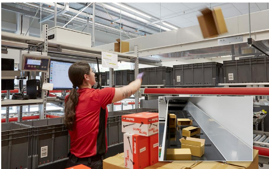
Ein Förderband (kleines Bild) transportiert die entleerten Kartonschachteln in den Aussenbereich, dort werden die Schachteln in einem Presscontainer verdichtet.
